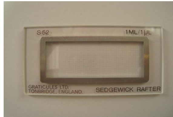
Abb. 8: Zählkammer von Sedgewick Rafter
