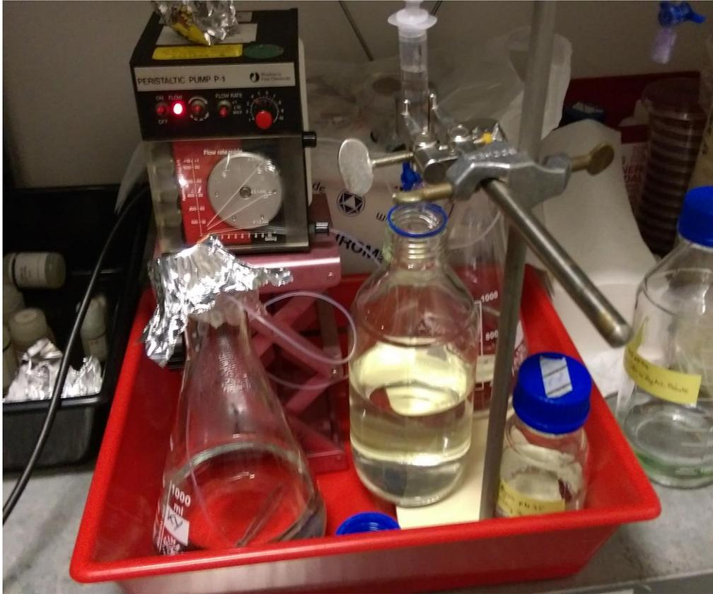
Abbildung 4: Aufbau der GST-Säule
